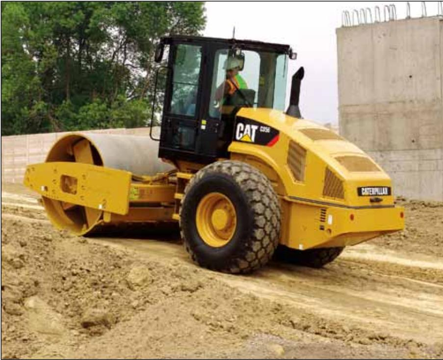
**Sistema de bombas dobles de propulsión**, con bombas dedicadas que impulsan independientemente la rueda trasera de alto par motor y servicio pesado y los motores del tambor. Si ocurre una pérdida de tracción en alguno de los motores, siempre se envía flujo hidráulico hacia el motor que no gira, lo que permite que la fuerza de tracción sea continua.
