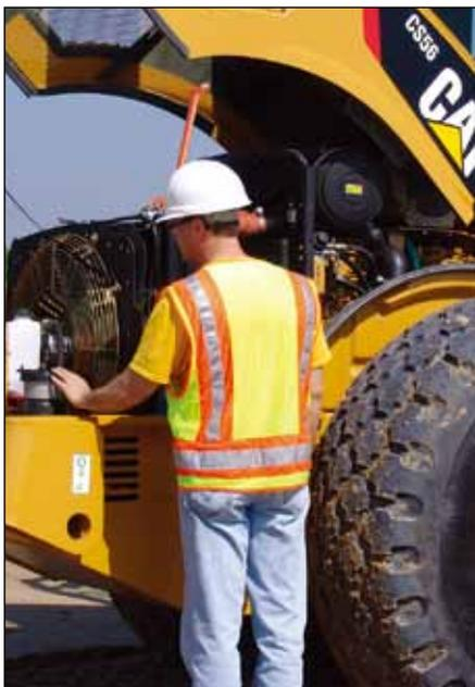
El capó de fibra de vidrio de una sola pieza se inclina hacia adelante para proporcionar un acceso excepcional al motor y al sistema de enfriamiento. Los puntos de servicio diario proporcionan acceso a nivel del suelo y están agrupados a un lado de la máquina.
