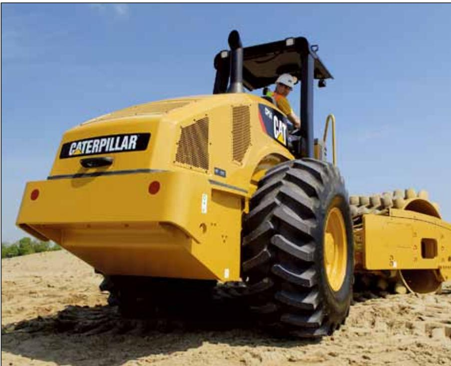
**Excepcional visibilidad hacia atrás** que proporciona línea de vista a los bordes de los neumáticos y a la parte trasera de la máquina. El operador puede ver obstáculos de 1 metro (3 pies 3 pulg) de alto, ubicados a 1 metro (3 pies 3 pulg) de la parte trasera de la máquina. Se ha disminuido el ancho de los guardabarros, al igual que el del parachoques trasero. La excelente visibilidad aumenta la productividad cuando se trabaja cerca de obstrucciones o se maniobra en el sitio de trabajo.
