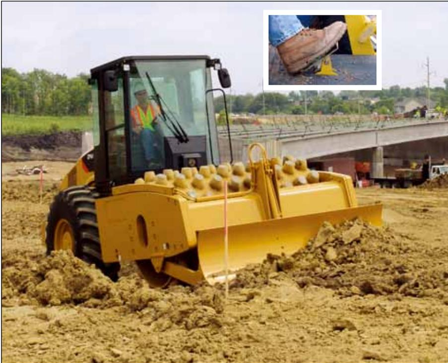
**Adecuada para muchas aplicaciones**, como demolición de materiales, nivelación de sitios, relleno de zanjas y explanación liviana.
