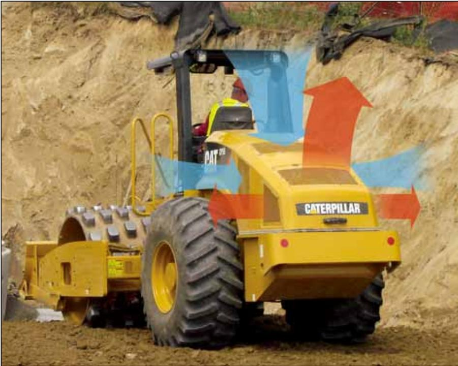
**Flujo de aire optimizado** que succiona el aire fresco de la parte media del capó y descarga el aire caliente por la parte trasera.
